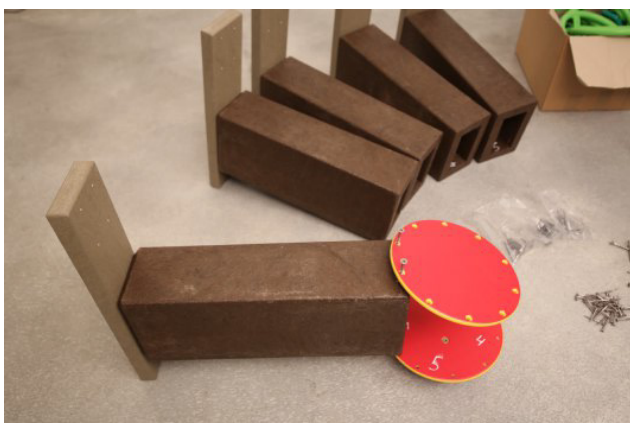
Schroef de bovenplaat vast op arm 1 (met respect voor de nummering) en steek arm 2 alvast tussen de platen
