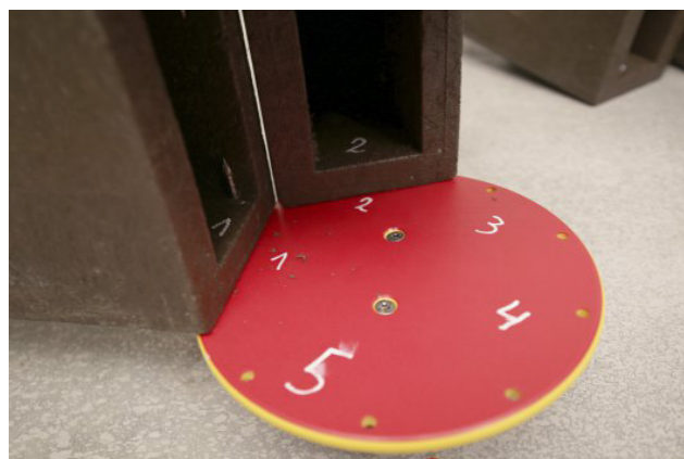
Schroef de bovenplaat vast op arm 1 (met respect voor de nummering) en steek arm 2 alvast tussen de platen
