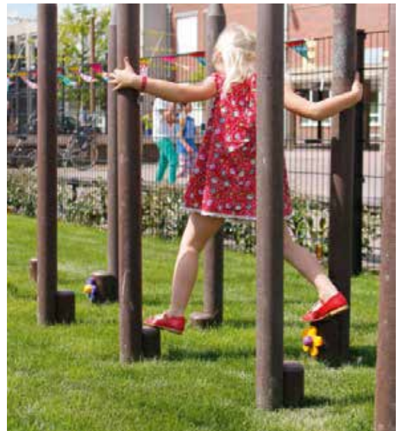
Configuration d'un piquet à l'autre en triangles équilatéraux de 60 cm
